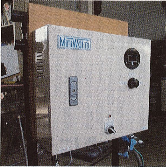
熱源器に電子ヒーターを利用して室内を暖房する
